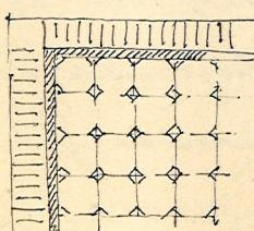
Grindet i Capellet udføres af helbrandede pressede gul <sup>otte</sup> sekantere og grå sekantere Fliser, med en cr.  $8\frac{1}{2}$ " bred Flis af røde pressede Mursten paa Kant og et cr. 2" tykt Skifte af grønt eller brunt glazurde Stein paa Kant. Kan sekantere Fliser ikke erholdes, anvendes sekantere efter nærmere Aftale
