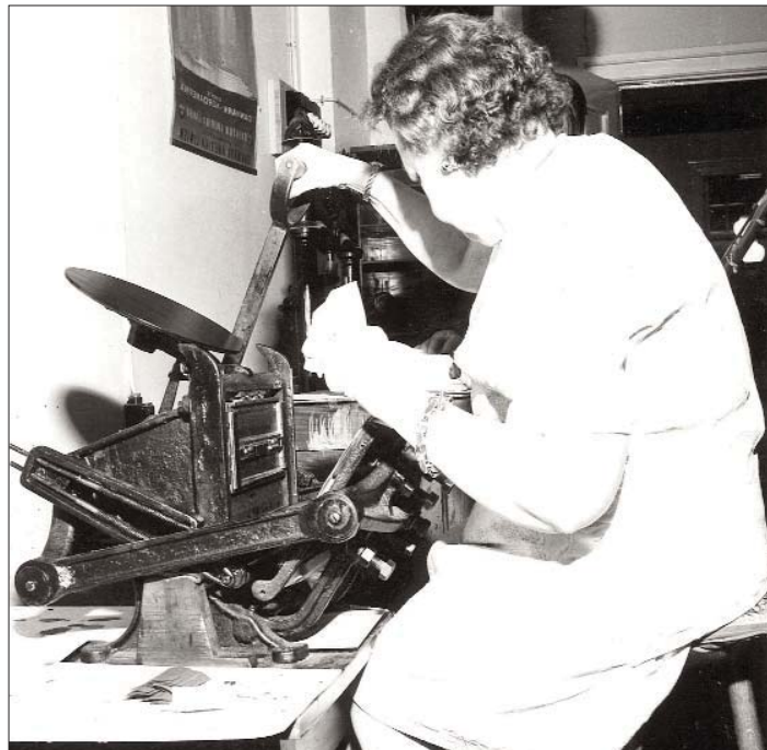
Fluesmækkeren: Et kærligt kaldenavn for en sejlivet lille trykmaskine, som er blevet anvendt i hospitalets trykkeri helt op i 1970'erne. Når man drejer på håndtaget på siden af maskinen, føres to valser op til og hen over tryksværten, hvorefter valserne på tilbagevejen påfører satsen en passende mængde trykfarve. Nu klapper fluesmækkeren sammen, og voila! – Vi har trykt en side.
